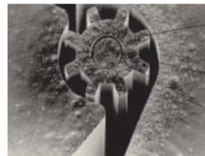
Микротурбина. Диаметр ротора 140 мкм
