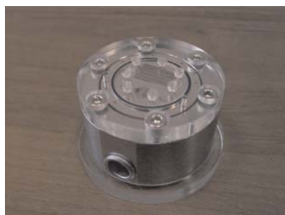
Микрореактор для смешивания двух жидкостей, состоящий из насосов и теплообменника
