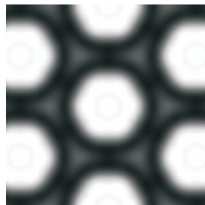
Синтез и структура мезоструктурированного силиката типа SBA-15, двумерно-гексагональная упаковка, диаметр мезопор ~10 нм, толщина стенки ~3 нм
