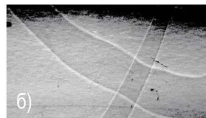
Фазоконтрастные изображения моделей кровеносных сосудов - капроновых лесок диаметром 1 мм в воде (а) и на воздухе (б)
