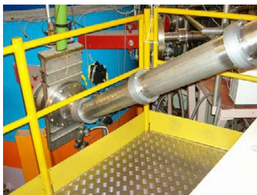
Рис.2. Нейтроноводная система большого диаметра (140 мм) в репликовой технологии на реакторе ILL.
