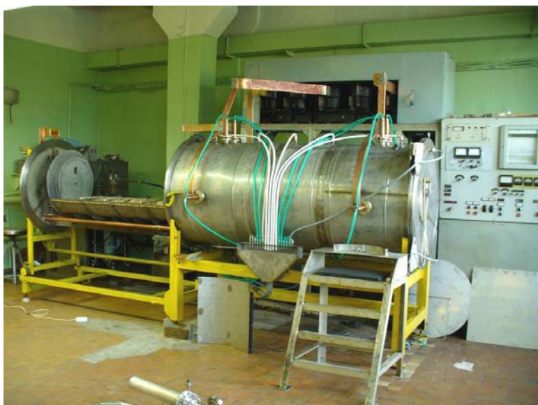
Рис.4. Вакуумная печь для отжига пермаллоя. Рабочая температура 1100 – 1200 0 С.
