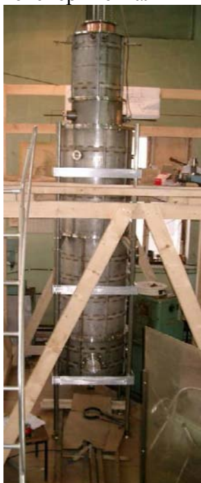
Рис. 1. Изготовление гравитационного спектрометра в ПИЯФ.
