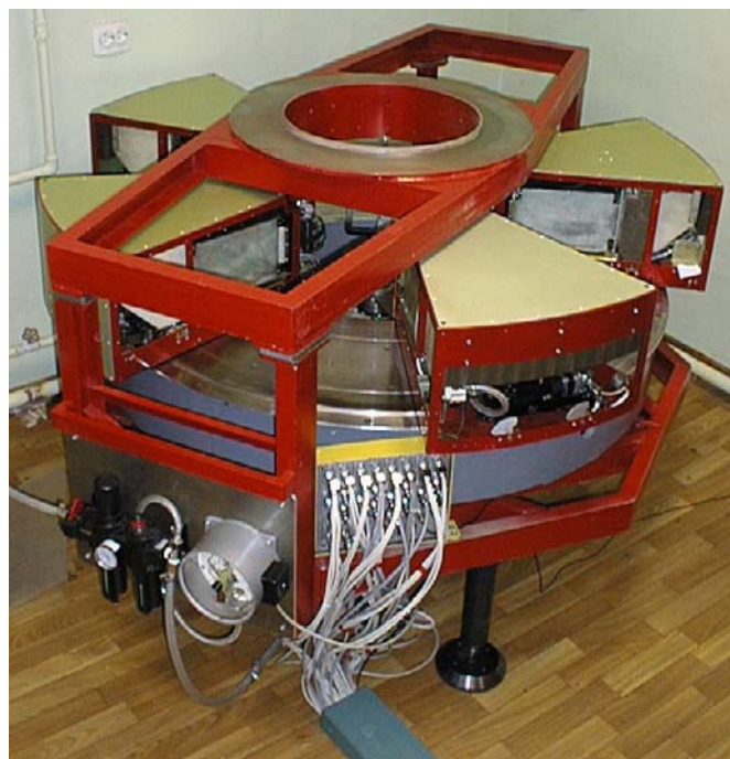
Рис.1. Дифрактометр при испытаниях вне нейтронного пучка.
