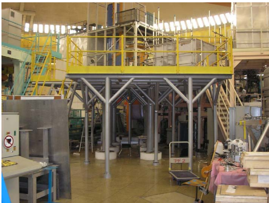
Рис.1. Немагнитная платформа установлена на пучке УХН реактора ILL.
