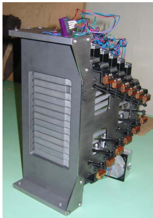
Рис.5. Внешний вид дистанционно управляемого фокусирующего монохроматора
