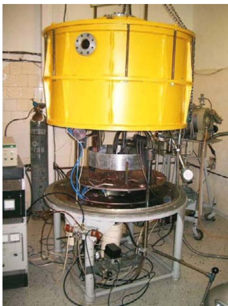
Рис. 1. Установка для напыления \text{Ni}^{58}\text{Mo} на стекло.
