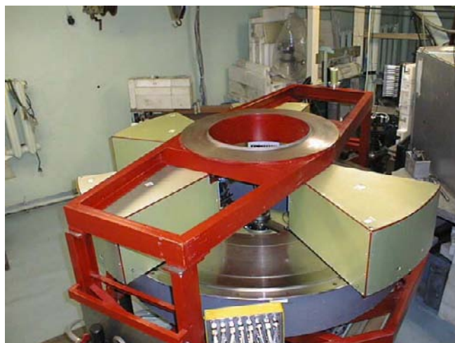
Рис.3. Дифрактометр при испытаниях на 9-ом нейтронном пучке реактора ВВР-М.
