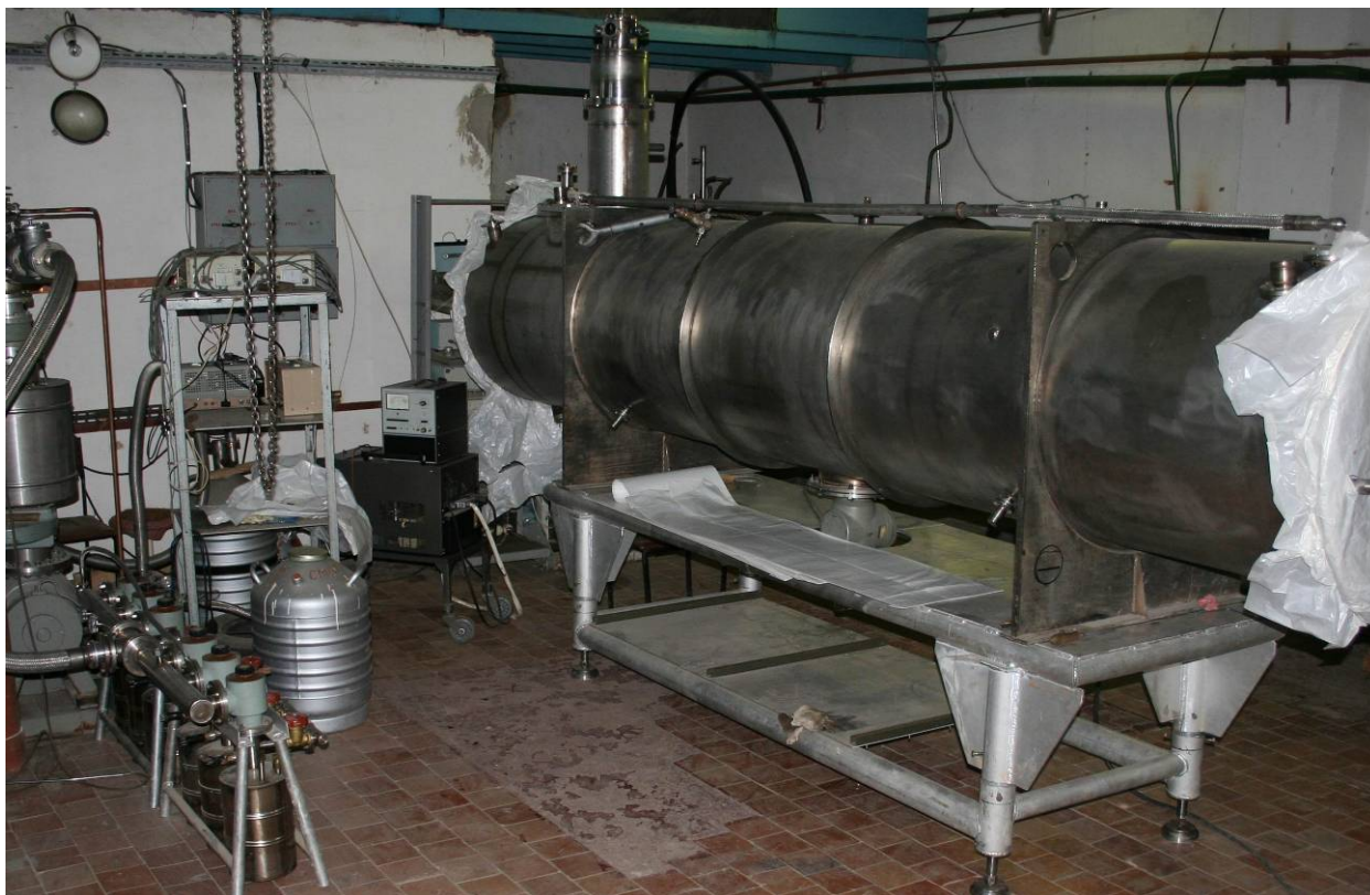
Рисунок. Сверхпроводящий соленоид для измерения асимметрий \beta -распада нейтрона (различные стадии сборки).
