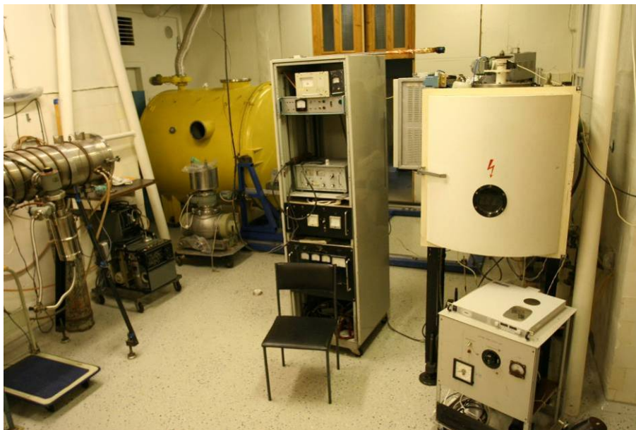
Рис. 2. Установка для напыления ^6\text{Li} на полупроводниковые кремниевые детекторы УХН (справа). Установка для напыления крупногабаритных цилиндрических ловушек изнутри, а также плоских поверхностей большого размера (дальний левый угол). Установка находится в стадии разработки.
